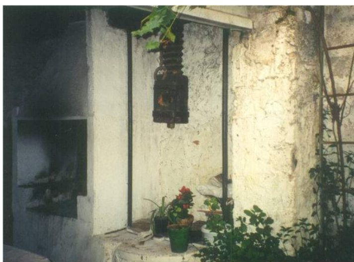
La prensa consistía en un grueso tornillo de madera que se enroscaba en una arandela fija en el techo. La cabeza del tornillo tenía un orificio por el que se atravesaba por una palanca que servía para desenroscar el tornillo y así apretar la uva estrujada que estaba en la jaula. El jugo fluía a través de las aberturas de la cesta. Podemos observar el tornillo de madera que apretaría el sombrero. Esta prensa dejó de funcionar en 1950.
