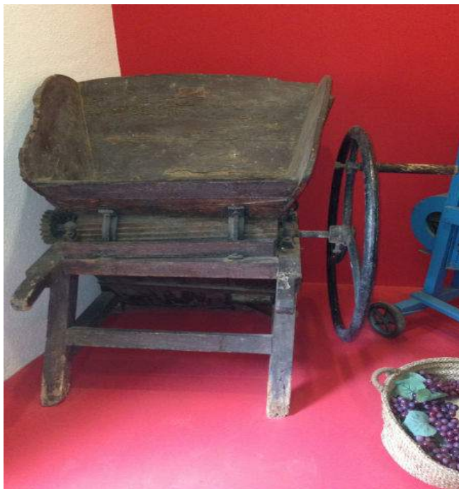
Pisadora de rodillos para vendimia. Estos artilugios manuales estrujaban en muy poco tiempo mucha uva y fueron sustituyendo el sistema de pisado en los cubos. Museo Etnológico Municipal de Castellón.
