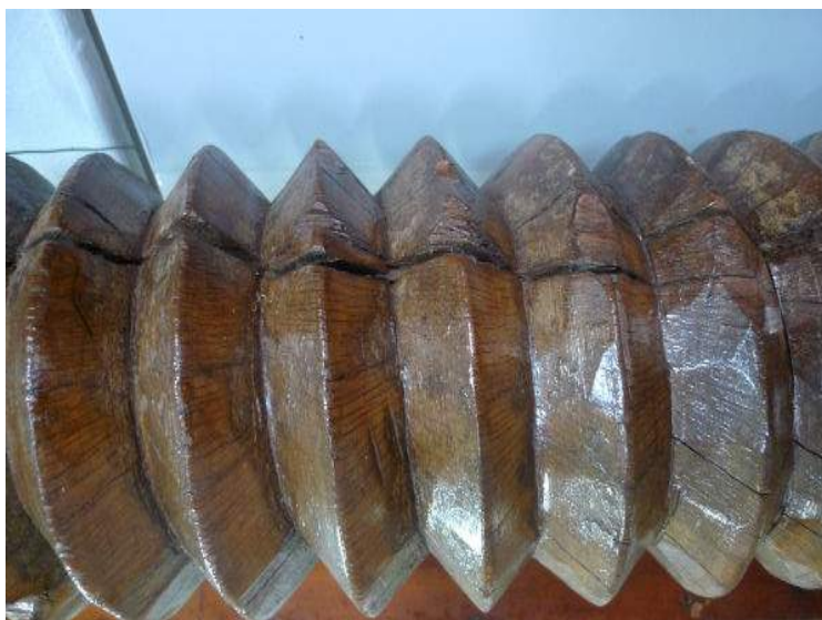
Antiguo tornillo de madera para prensa de vino recuperado por la Bodega Viña Viver Sanjuán. Dada la fragilidad de la madera los tornillos de las prensas se hacían de las maderas más duras como cerezo, sabina o latonero y eran muy gruesos para poder resistir la fricción. Foto Xaro Nomdedéu.
