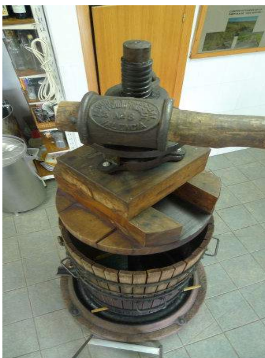
Prensa vertical de hierro y madera en torno a 1860 recuperada en la bodega Viña Viver Sanjuán, primera bodega moderna de Viver que estuvo en actividad desde 1991 hasta 2014. Las primeras prensas de hierro tenían la misma estructura que las tradicionales de madera y se propagan a partir de la creación en Valencia de la Fundación Primitiva Valenciana en 1850. El funcionamiento de todas las prensas se basa en el principio de Pascal, según el cual la presión ejercida sobre cualquier punto de un líquido se transmite en igual intensidad en todos los sentidos. Foto Xaro Nomdedéu.
